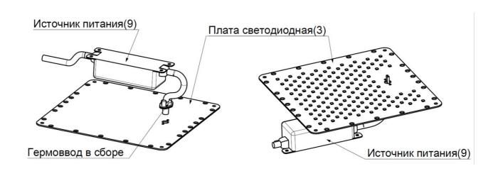
3. Установить гермоввод (7) на плату светодиодную зафиксировав винтами гермоввода (5).
