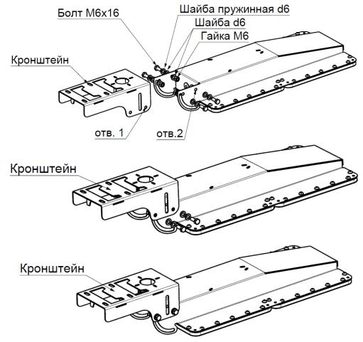
2. Установить хомут на кронштейн, закрепив используя Гайку хомута M6, Шайбу хомута d6
