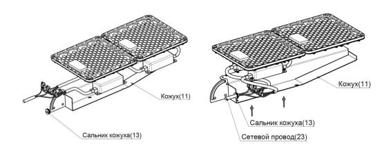
10.3акрепить заклепками 4x10 (10), предварительно продев через шайбу усиленную d4 (8), источник питания (9) на кожухе (11).
