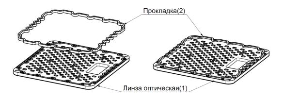
6. Установить линзу оптическую (1) на плату светодиодную (3) сопоставив выступы на линзе оптической (1) с отверстием на плате светодиодной (3), закрепить линзу оптическую на плате светодиодной винтами М5х7 (4) в указанном порядке, в количестве 10шт.
